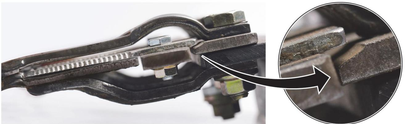
Если направляющая планка изношена, нож утрачивает прочность посадки и поэтому может плавать в зазоре среза. На рисунке видно, что угол 90° направляющей планки изношен. Изношенная направляющая планка больше не
